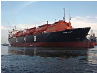
LNG Ship "Golar Spirit" converted into LNG Regas Terminal
