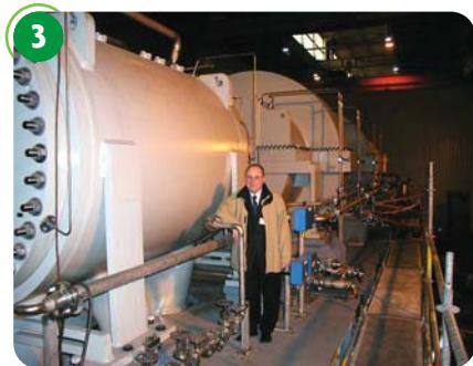
**3** Une section de compression qui va faciliter la séparation ultérieure des gaz. Un turbo-compresseur peut mesurer jusqu'à 24 mètres de long pour un poids de l'ordre de 450 tonnes.
