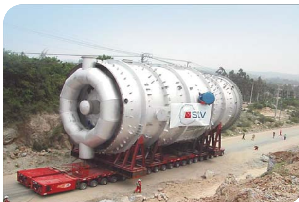
Réacteur Hitachi de 650 tonnes pour la raffinerie de Dung Quat (Vietnam)
