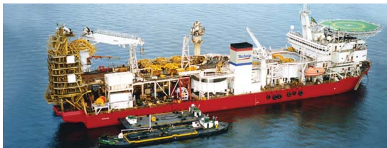
Sunrise 2000 : navire de pose de pipelines
