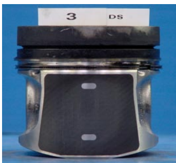
Bild 7: Kolben nach 3000-h-Lauf
